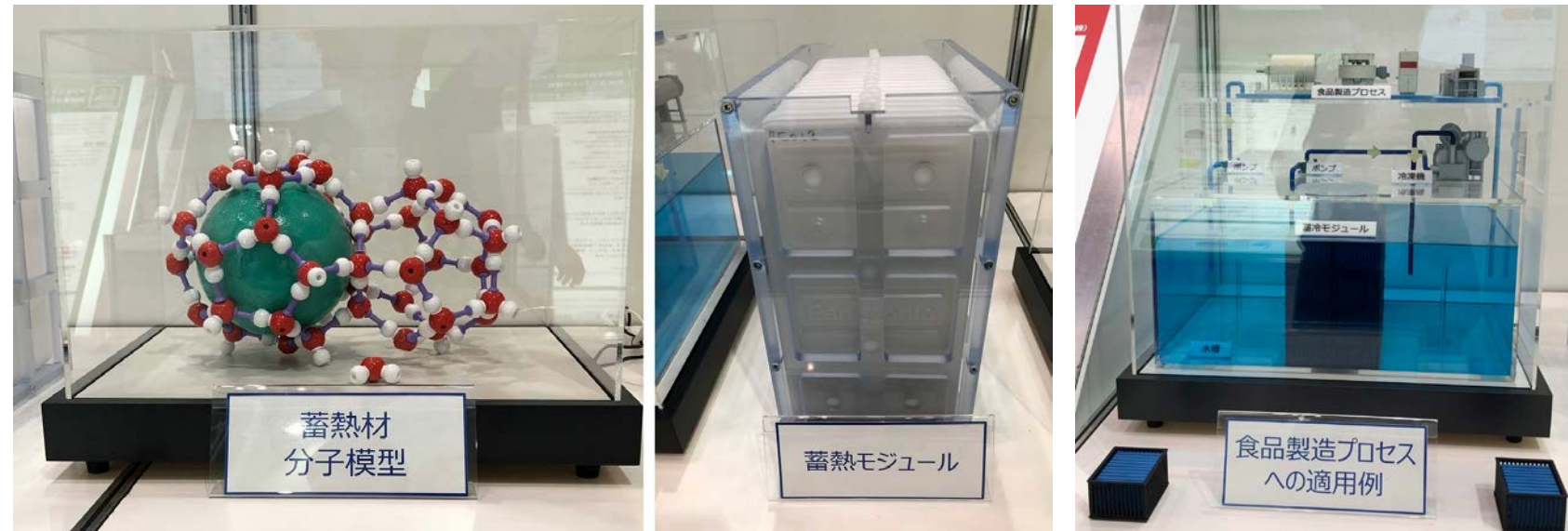
図1 クラスレートハイドレートの分子構造と蓄熱モジュール
